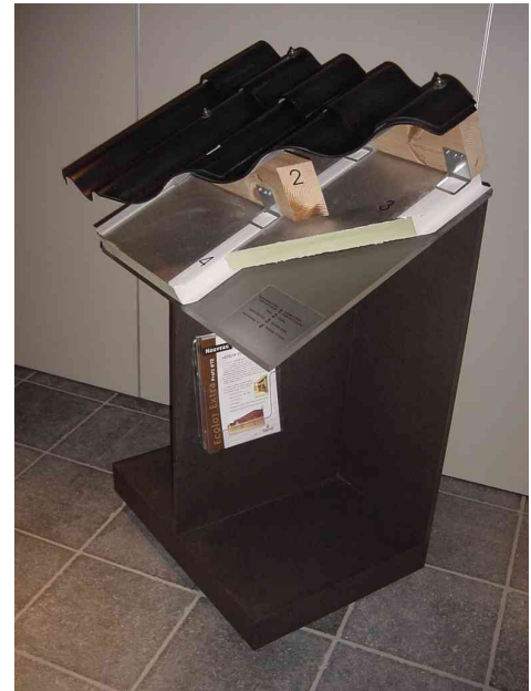
Foto 6: Golfplaten met isolatie onder de gordingen
